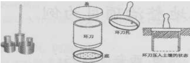
图 3 环刀及土壤容重采样示意图
